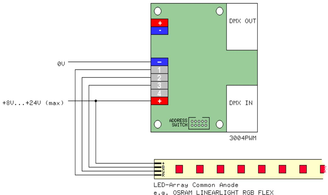
Bei dieser Anschlußart ist eine besondere Speisung für die Decoderplatine 3004PWM nicht erforderlich, da sie aus der LED-Versorgung mit gespeist wird. Umgekehrt könnte die LED-Versorgung aus der Platinspeisung erfolgen, jedoch muß dann der Laststrom über die Platine geführt werden
