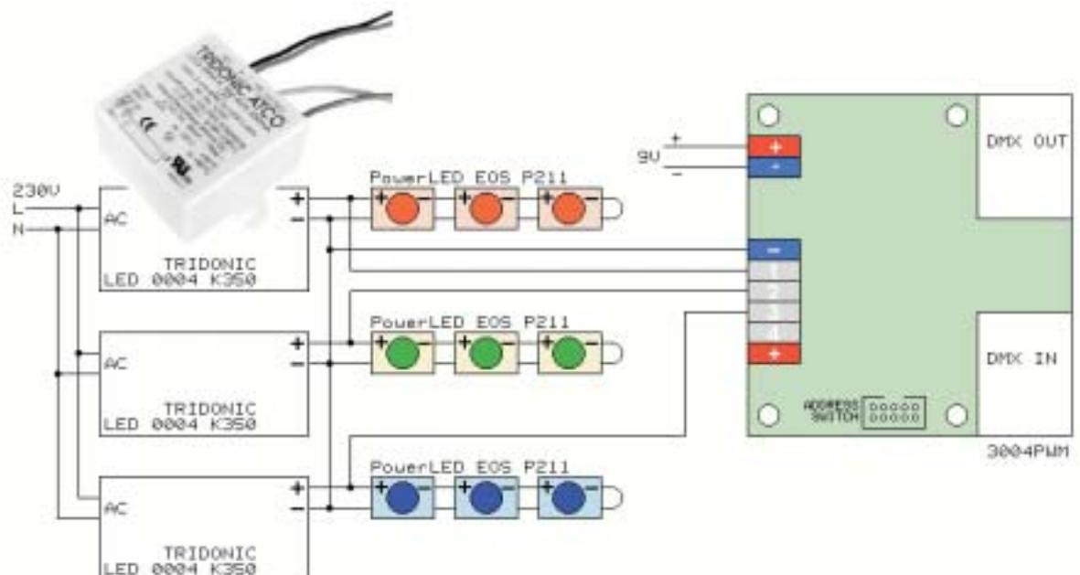
dazu genügt z.B. ein 9V Steckernetzteil (z.B. PS-926DC). Da es sich um einen Shuntregler handelt, ist die Regelrichtung invertiert und muss daher durch Setzen des DIP-Schalters 4 korrigiert werden.
