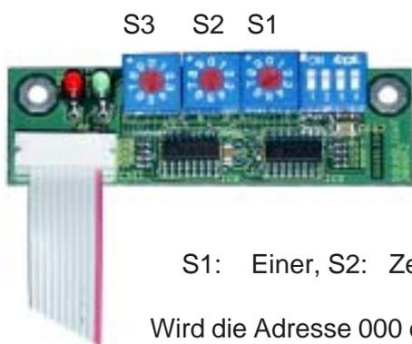
Mit den Codierschaltern wird die Startadresse, d.h., die Nummer des ersten zu dekodierenden Kanals eingestellt. Die Einstellung erfolgt numerisch dezimal, es ist also keine Binärumsrechnung wie bei DIL-Schaltern erforderlich.
