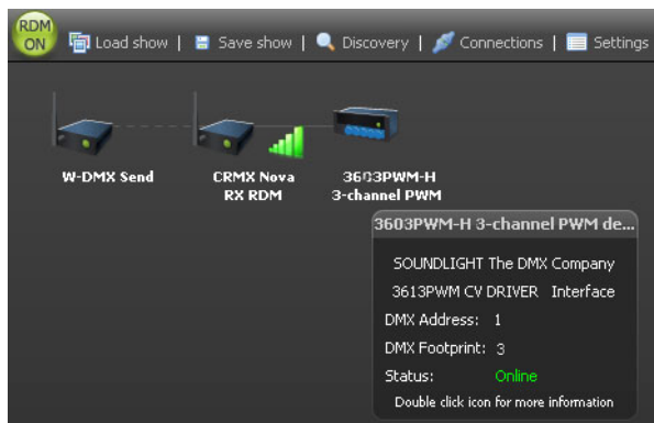
Erkennung der 3603PWM-H über Wireless RDM (Bild: Aufnahme mit CRMX Nova Software)
