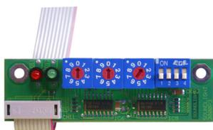
Schalterkarte mit DIP-Schaltern zur Parameterkonfiguration
