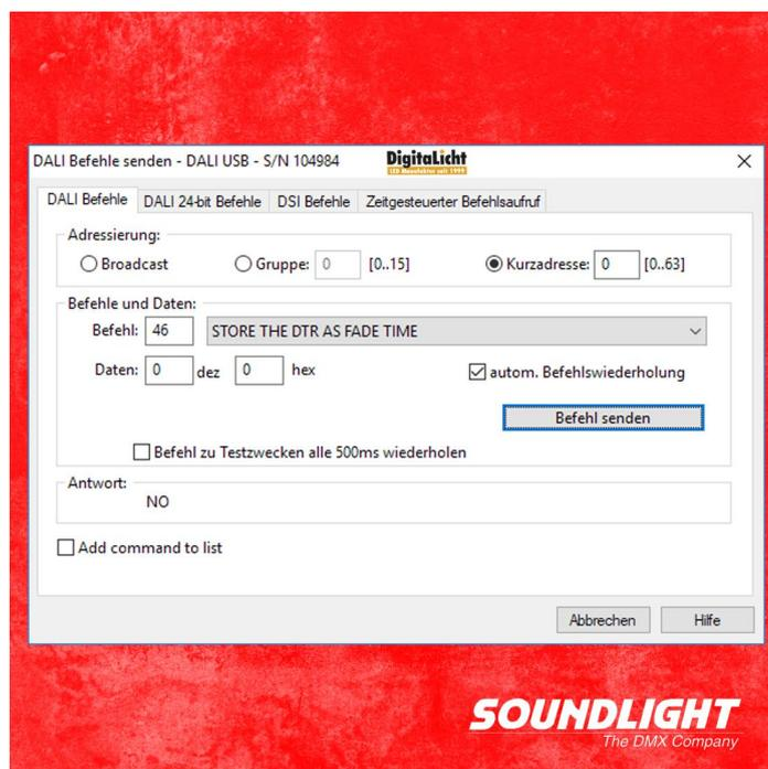
Wählen Sie Befehl 257, um den Wert 5 in das Kommandoregister zu laden. Kopieren Sie dann das Befehlsregister in das Fadezeit-Register.
